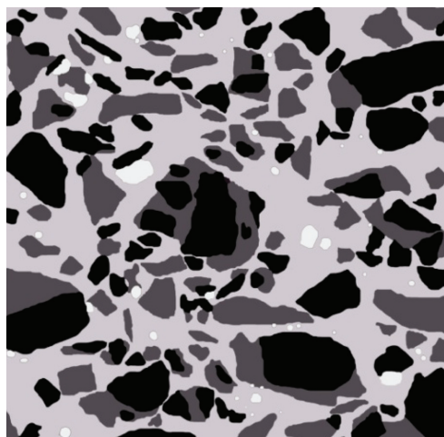
6 pav. Betono bandinio, pažymėto žymeniu B, vaizdas: balta spalva pažymėtos poros; šviesiai pilka – naujai susidaręs cemento akmuo su smulkiuoju užpildu; tamsiai pilka ir juoda – betono atliekos (tamsiai pilka – cemento akmuo su smulkiaisiais užpildais ir juoda – stambieji užpildai)
