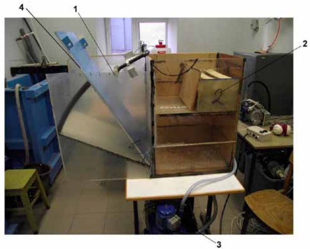
1 pav. Ežektorinio aušintuvo eksperimentinis tyrimų stendas: 1 – reguliuojamos padėties vandens purkštukas; 2 – oro ir vandens separatorius; 3 – vandens siurblys; 4 – konfuzoriaus įėjimo angos kampo reguliatorius
