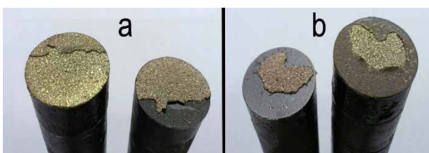
10 pav. CuAl8 bronzos bandiniai po statinio tempimo bandymo
