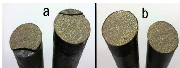
11 pav. Kombinuotos dangos bandiniai po statinio tempimo bandymo
