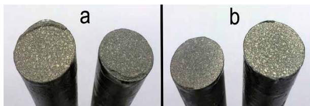
9 pav. 316 nerūdijančiojo plieno bandiniai po statinio tempimo bandymo
