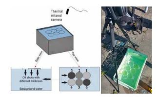
Fig. 1. Diesel detection using infrared camera 1 pav. Dyzelino aptikimas naudojant infaraudonųjų spindulių kamerą
